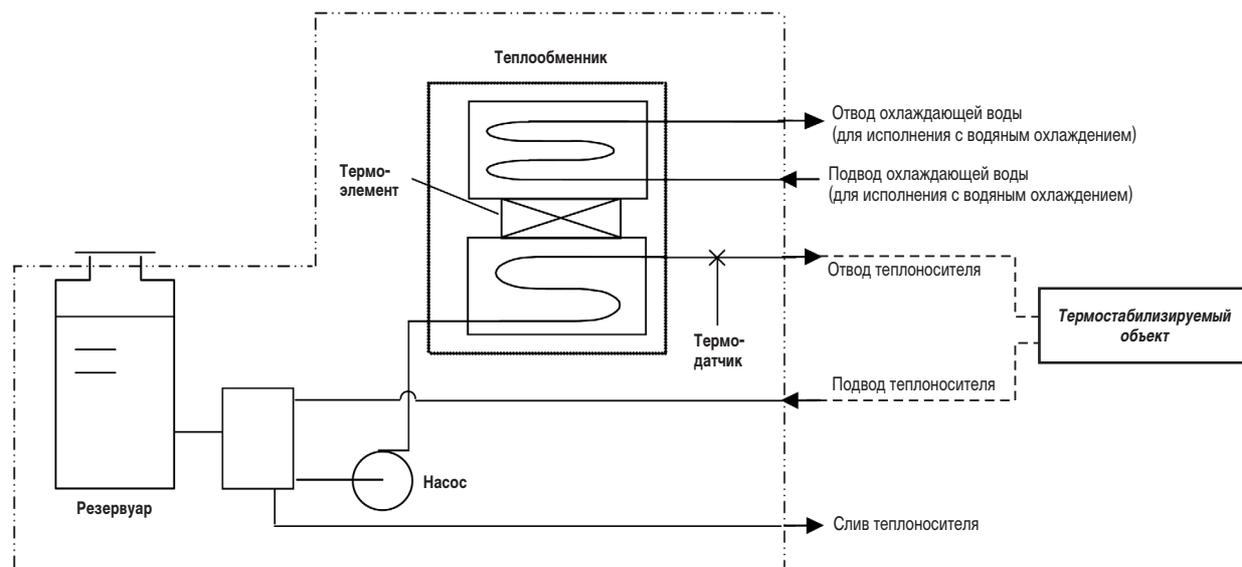
Постоянный ток на термоэлемент (модуль Пельтье) поступает от импульсного источника питания, управляемого контроллером, который обрабатывает показания установленного на выходе теплообменника датчика температуры теплоносителя.
